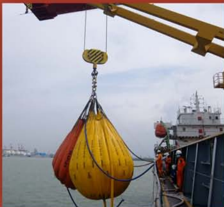
CRANE LOAD TEST-MV KEDUNG MAS (Terminal Peti Kemas SBY, Th. 2021)
